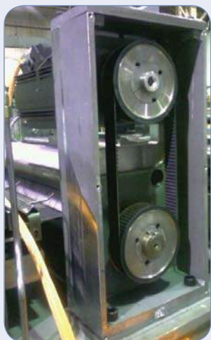
采用传统伺服电机、齿轮头、皮带和皮带轮制造的冲床给料机器。
